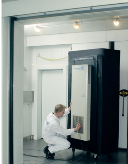
Labortest zum Einsatz von CO 2 als Kältemittel in Pfannenberg Klimatisierungsgeräten.
